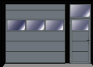
Opgelijnd met overheaddeur met beglaasde sectie
